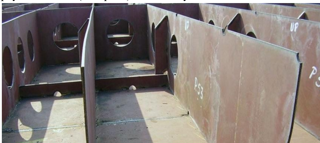
Рисунок 4. Предварительная сборка и сварка корпусных конструкций
