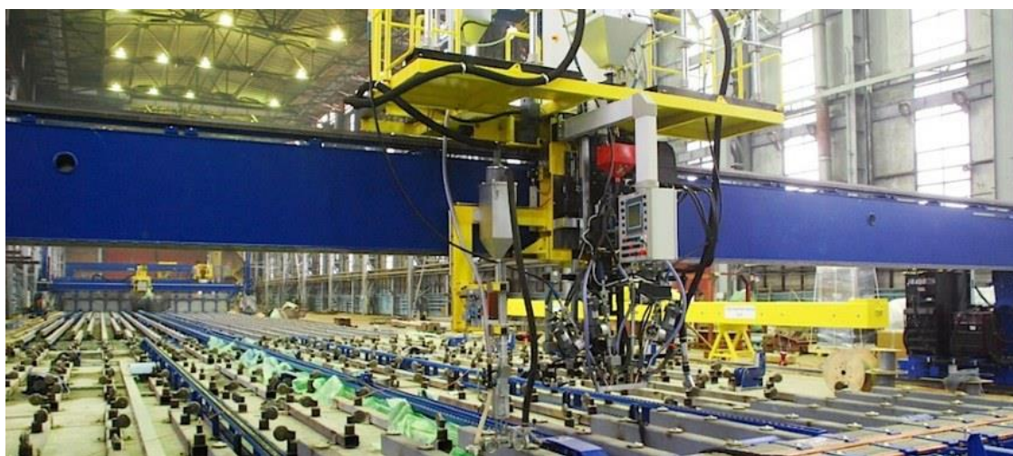
Рисунок 6. Линия сборки корпусных деталей судна
